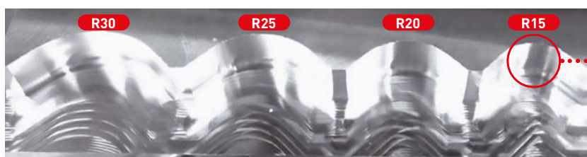
Vc = 200 m/min, R15, détail des surfaces usinées
